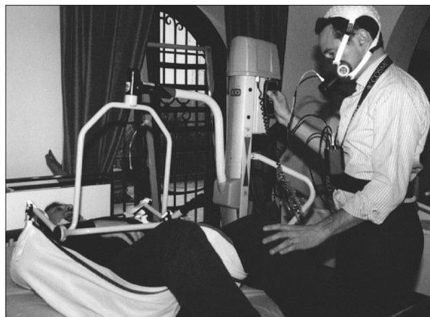
Figura 1. *L'immagine rappresenta un operatore che indossa un sistema telemetrico di misura del consumo di O<sub>2</sub> durante un'azione di sollevamento eseguita mediante sollevatore elettromeccanico a corsetto dotato di sistema "a cambio postura"*
