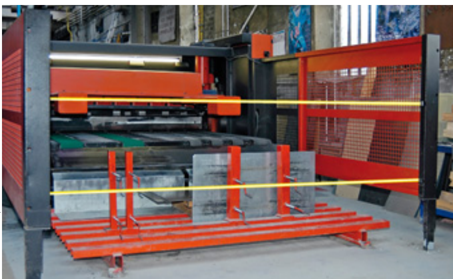
Fig. 9. Protection immatérielle de la zone arrière d'une cisaille guillotine.
