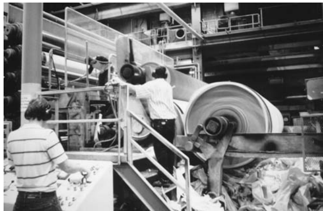
Figure 72.10 • Extrémité sèche d'une machine à papier, où l'on voit le papier entièrement enroulé et un travailleur occupé à le couper à l'aide d'un couteau circulaire
