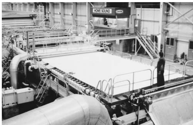
Figure 72.9 • Extrémité humide de la machine à pâte, où l'on voit le matelas étalé sur la toile
