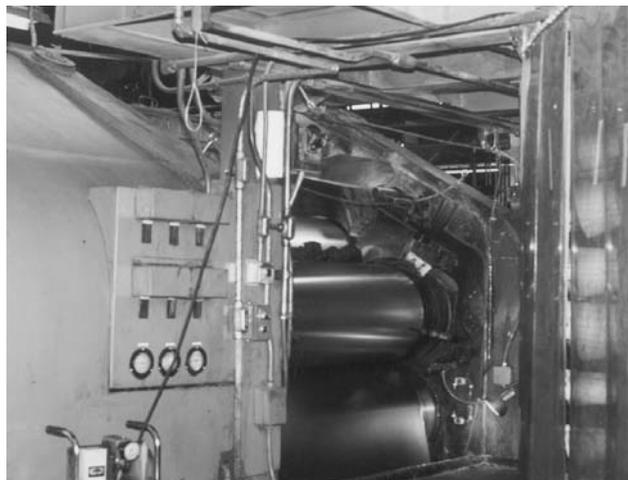
Figure 80.7 • Assemblage d'un pneumatique sur une machine simple
