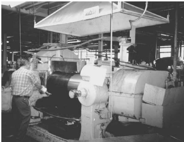
Il est équipé d'une barre d'arrêt placée trop haut pour être efficace. Toutefois, l'opérateur porte des gants surdimensionnés qui protègent bien les doigts s'ils sont happés par la machine.
