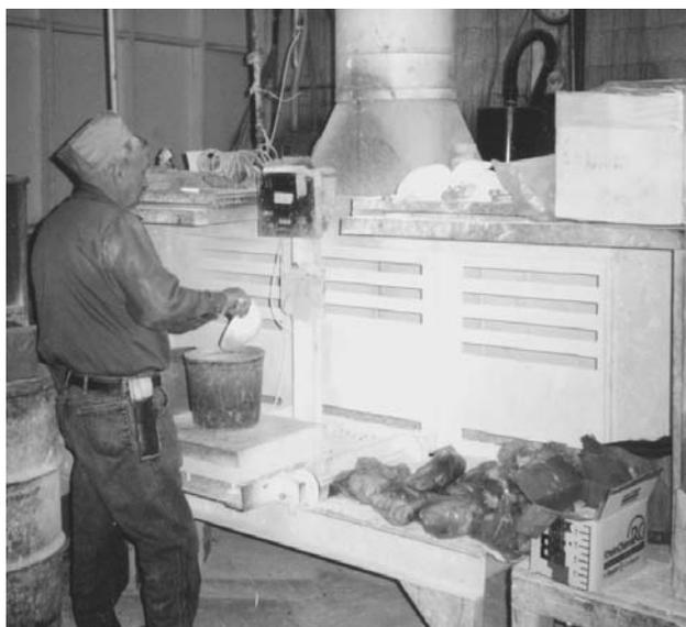
Figure 80.13 • Un rideau installé au bord de la hotte au-dessus d'un malaxeur limite la dispersion des poussières
