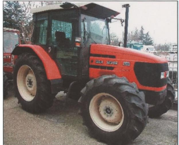
I trattori a ruote, con carreggiata superiore ad 1 metro, devono avere telaio o cabina di protezione.
