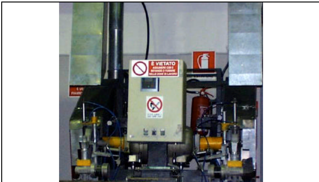
Fig. 12 Smerigliatrice a doppio albero - La postazione è composta da un motore elettrico ad asse orizzontale dotato di due mandrini laterali che azionano le pulegge di trascinamento.
