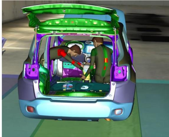
Figure 8. Simulazione realtà immersiva montaggio mobiletto centrale
