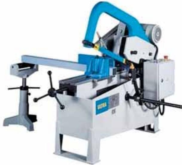
Macchina utensile per il taglio a freddo dei metalli tramite un utensile costituito da una lama dentata il cui movimento alternato è dato da un sistema biella-manovella. Il pezzo viene bloccato sul piano macchina mentre la testa, sulla quale è montata la lama, si abbassa automaticamente in seguito all'avviamento.
