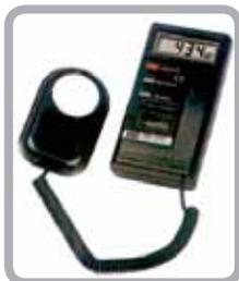
Tutti gli apparecchi di misura fotometrici funzionano tramite un ricettore che trasforma i fotoni (luce) che colpiscono la cellula di un cristallo (di solito in silicio) in corrente elettrica. Il silicio trasforma la luminanza  $L$  in una corrente  $I$  proporzionale.
