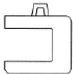
**Gancio a C: dispositivo a** forma di 'C' utilizzato per il sollevamento di carichi cavi come ad es. bobine, tubi, ecc.
