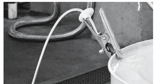
Fig. 2: morsetto di messa a terra collegato a un bordo del fusto.
