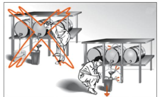
Fig. 3: durante il travaso di liquidi facilmente infiammabili bisogna collegare tra di loro e mettere a terra i recipienti, gli imbuto e i fusti conduttori. Anche gli scaffali devono essere messi a terra.
