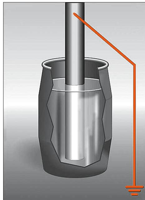
Fig. 5: durante il travaso di liquidi facilmente infiammabili bisogna inserire il tubo o il flessibile per il travaso fino in fondo al recipiente; inoltre il tubo o il flessibile deve essere messo a terra.
