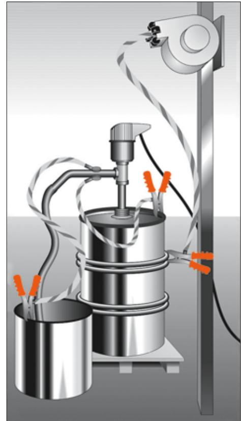
Fig. 1: il collegamento equipotenziale e la messa a terra sono misure importanti contro la formazione di cariche elettrostatiche.
