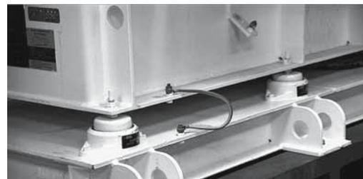
Fig. 4: tutte le parti conduttrici dell'impianto devono essere collegate tra di loro e messe a terra.
