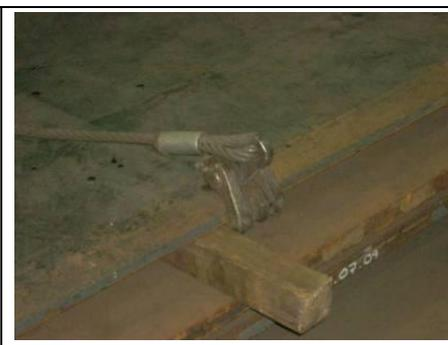
Quando si usa il carroponte tradizionale la presa della lamiera è fatta utilizzando una delle attrezzature indicate nelle foto qui sopra.
