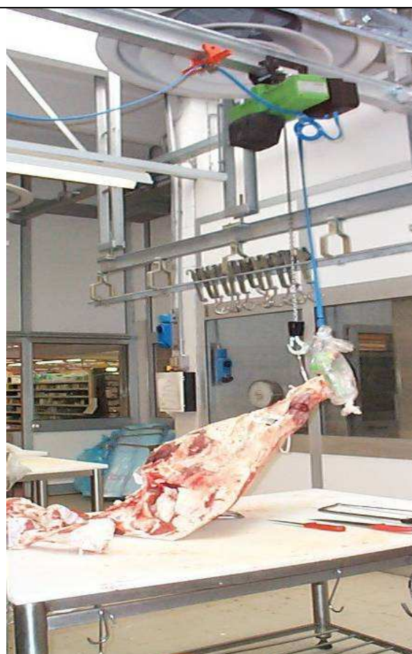
Fig. 12 – apparecchio di sollevamento (interno) di quarti e mezzene per passaggio da guidovia a banco di taglio
