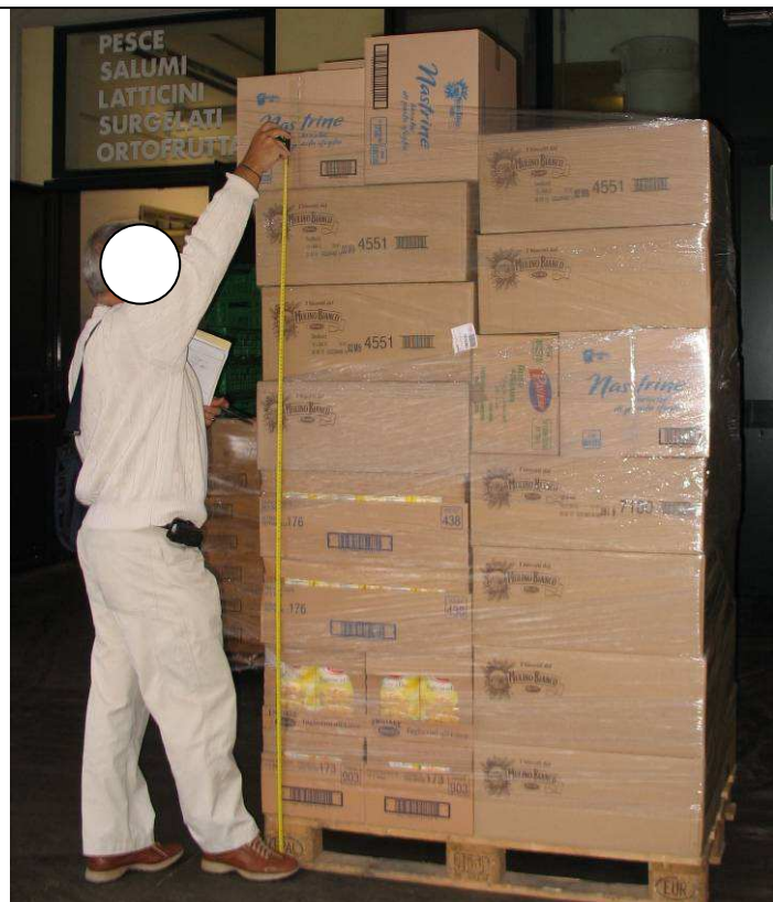
Figg. 9 e 10 – esempio di altezza dei pallet in ingresso > 175 cm (necessità di misura di prevenzione)
