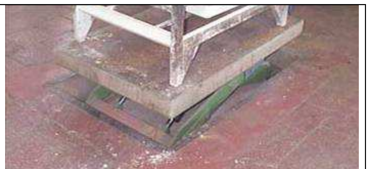
Figg. 7 e 8 – esempio di pedana industriale elevabile interrata che consente di migliorare l'altezza di presa della merce da movimentare quando arriva nelle condizioni di figg. 9 e 10)
