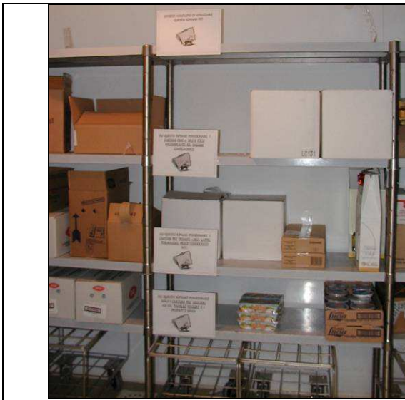
Fig. 20 – reparti, aree "retro" e celle frigorifere: scaffalatura con altezza adeguata e indicazione dei pesi/merci da collocare
