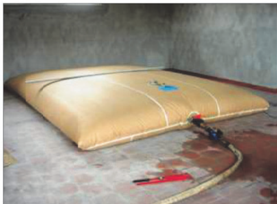
PROVA DI CARICO STATICA SU SPECCHIATURA DI SOLAIO LATERO CEMENTIZIO
