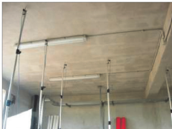
PROVA DI CARICO STATICA SU SPECCHIATURA DI SOLAIO LATERO CEMENTIZIO
