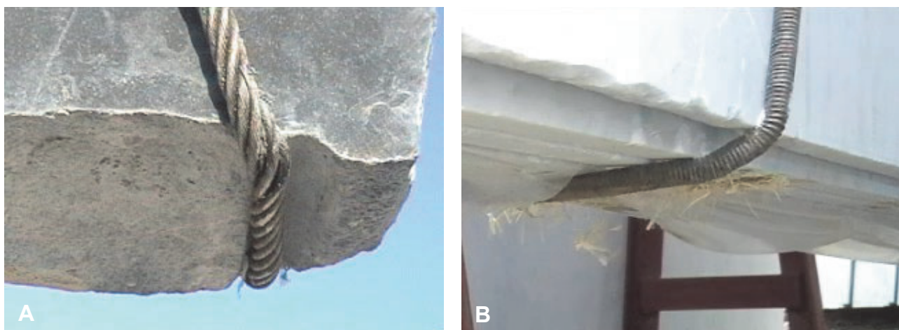
Fig. n. 18: Braca deformata sullo spigolo: A) braca non protetta, B) braca protetta.
