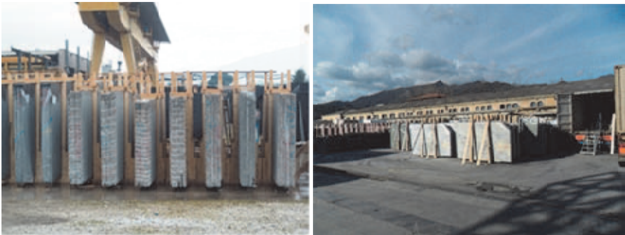
Figg. n. 50, 51: Stoccaggio con legacci
