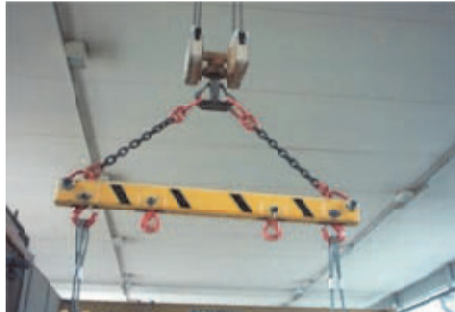
Fig. n. 27: Bilancino con quattro attacchi
