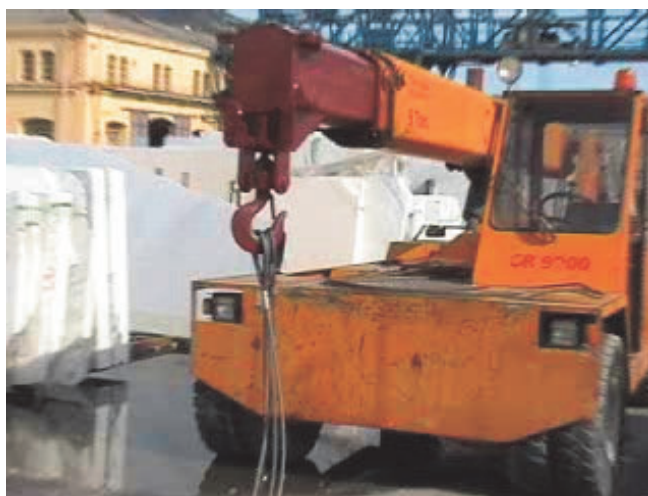
Fig. n. 13: Gru con gancio a rotazione comandata
