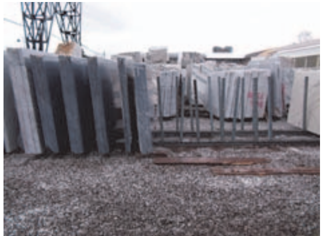
Fig. n. 44, 45: Stoccaggio con paletti (rastrelliere)
