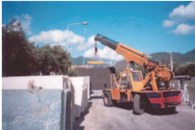
Fig. n. 28: Trasporto lastre con bilancino
