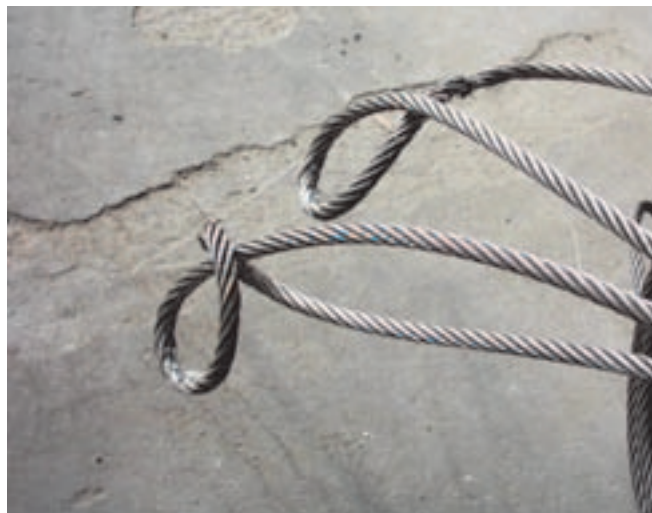
Fig. n. 17: Coppia di brache deformate "a ricciolo" con segni di usura
