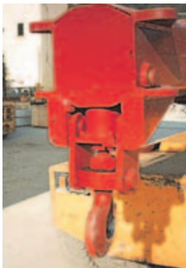
Fig. n. 14: dettaglio gancio a rotazione comandata
