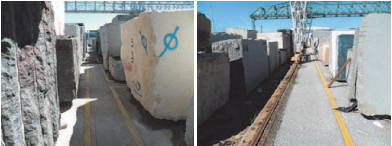
Figg. n.5, 6: La via di circolazione in sicurezza dei pedoni
