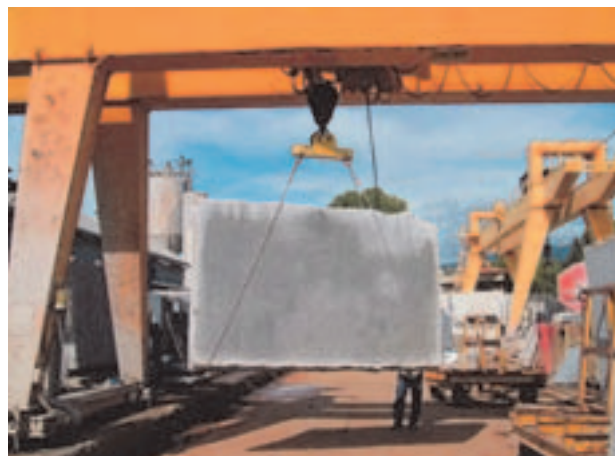
Fig. n. 38: Imbracatura pastello con bilancino corto
