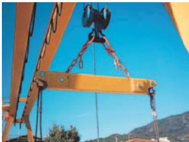
Fig. n. 26: Bilancino collegato alla gru
