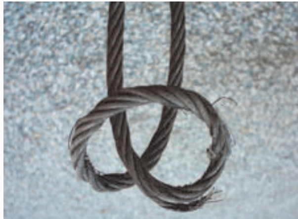
Fig. n. 16: Braca deformata e danneggiata
