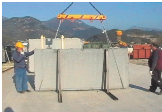
Fig. n. 29: Deposito pastello con bilancino
