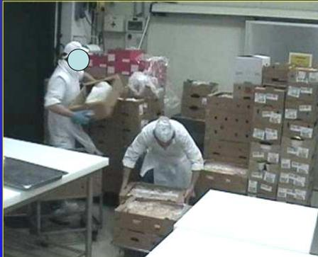
esempio di spazi **inadeguati** per uso corretto del carrello elevatore e per la movimentazione ergonomica dei carichi (→ **misura di prevenzione**)
