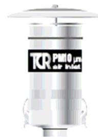
I due sistemi di campionamento sono stati collocati in posizioni adiacenti (circa 30 cm di distanza tra le teste), alla stessa altezza da terra (circa 1.50 m) ed hanno operato rigorosamente in simultaneo (fig. 4).
