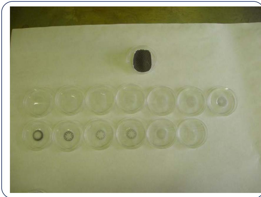
**Figura 6** - I 13 stadi di raccolta dell'impattore con i 13 filtri in alluminio (frazioni da 0.03 a 10 µm) dopo il campionamento
