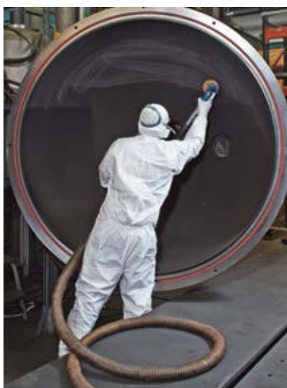
Figura 5 Pulire le cabine di spruzzatura con aspiratori industriali omologati e dispositivi di protezione individuale.
