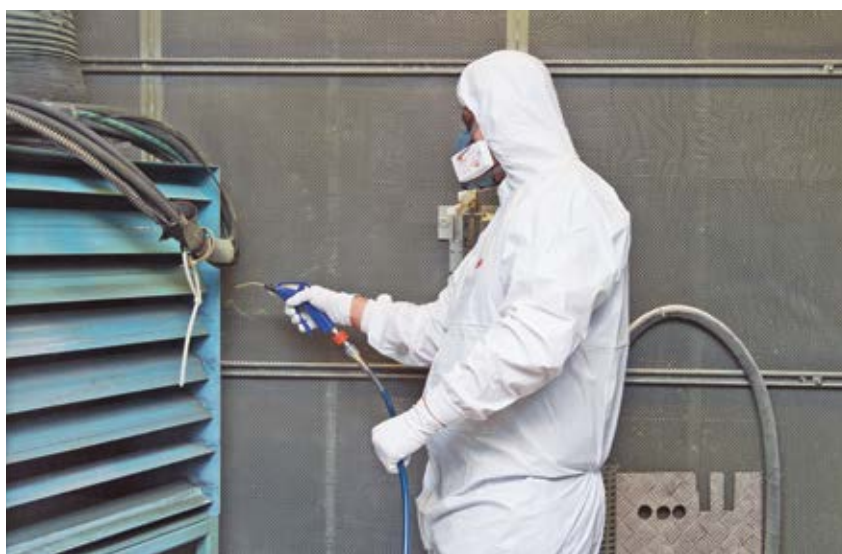
Figura 6 L'aria compressa può essere utilizzata per la pulizia soltanto se, per motivi tecnici, non ci sono altre possibilità e se il sistema di aspirazione della cabina è in funzione.
