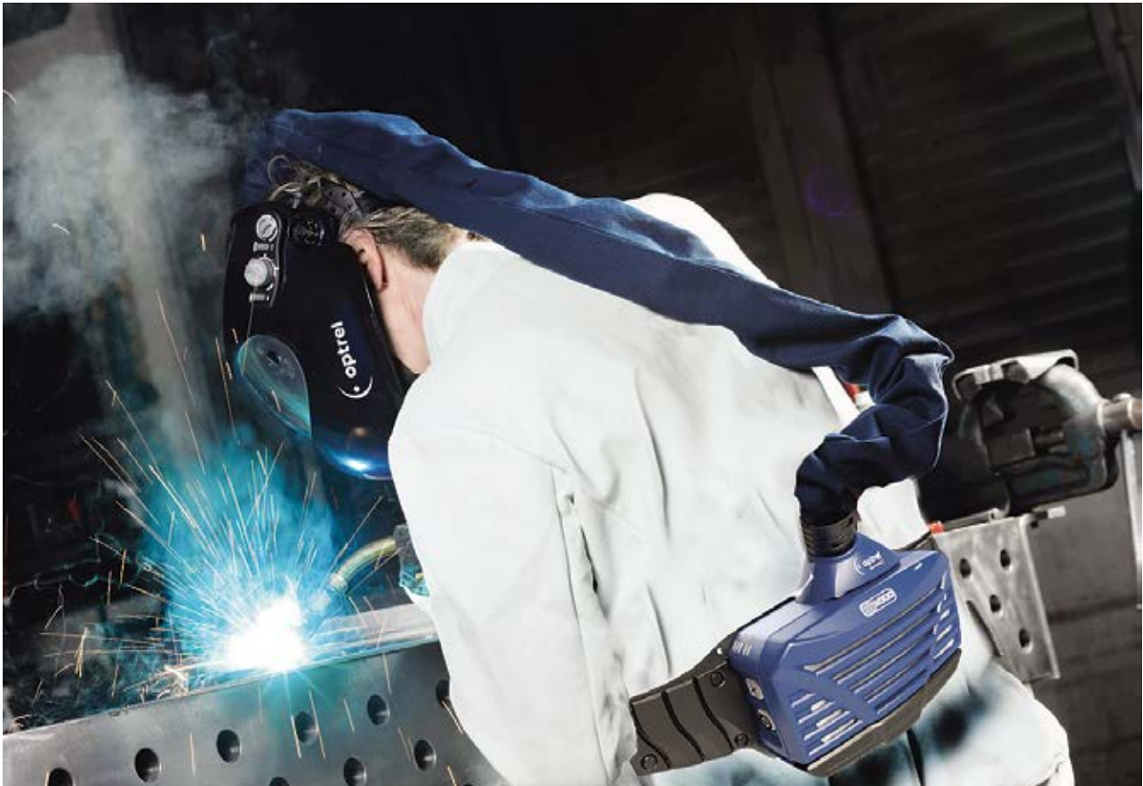
Figura 3 Protezione delle vie respiratorie durante la saldatura MIG/MAG: dispositivo filtrante a ventilazione assistita con casco di saldatura e filtro antiparticolato multiuso di classe TH3P R SL.
