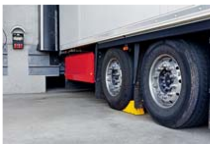
1 Veicolo messo in sicurezza con gli appositi cunei al punto di carico
