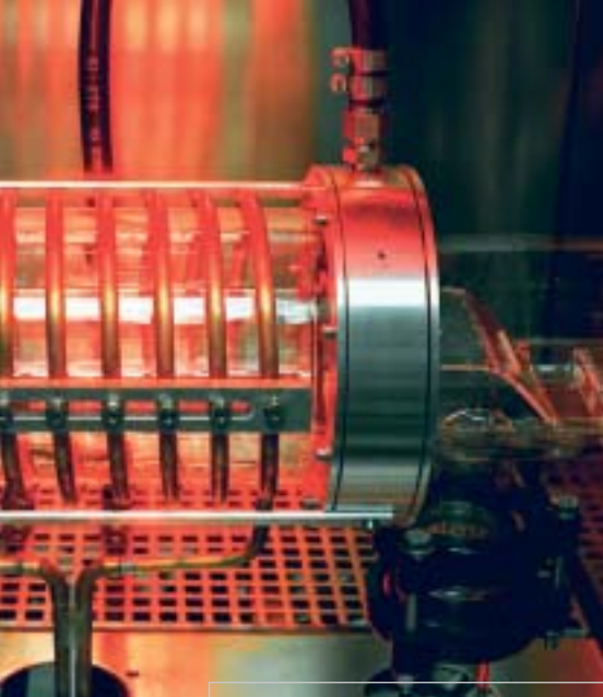
Reattori Aixtron per la ricerca (a sinistra) e per produrre con precisione atomica strati sottili di semiconduttori di giunzione (a destra).
