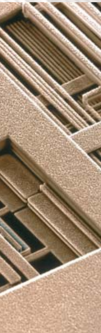
Complessi come una città: i circuiti di rame di un chip (IBM) visti al microscopio a scansione elettronica. I chip moderni hanno fino a nove livelli di circuiti.
