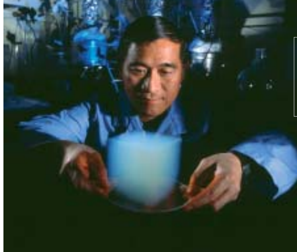
L'aerogel è un acchiappa polvere per fini scientifici. Le particelle restano intrappolate in una massa fusa di aerogel.
