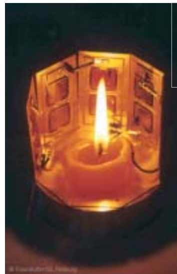
Ad una cella termofotovoltaica basta la luce di una candela per produrre la corrente necessaria a far funzionare una radio.
