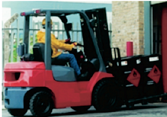
Figura 9: Carrello elevatore destinato ad una zona con atmosfera potenzialmente esplosiva
