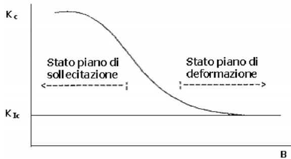
Figura 13: Diminuzione del fattore d'intensità degli sforzi critico K_c con lo spessore B del provino
