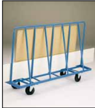
Figura 27 Carrello portapannelli. Per trasportare pannelli (legno, acciaio, plastica, vetro) del peso fino a 500 kg circa. Uso tipico: ricezione merci, produzione, montaggio, magazzino.
