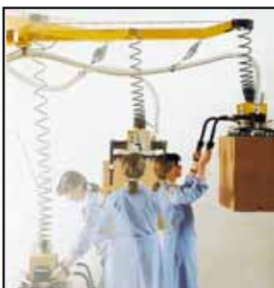
Figura 41 «Balancer» per molti tipi di carichi. Per spostare carichi del peso fino a 100 kg circa. Uso tipico: produzione, montaggio, commissionamenti.
