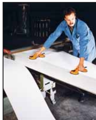
Figura 45 Organi di presa a ventosa. Per trasportare e posizionare pannelli lisci (acciaio, plastica, vetro) del peso fino ad 80 kg circa. Uso tipico: entrata e uscita merci, produzione, montaggio, magazzino, consegna merci, manutenzione.
