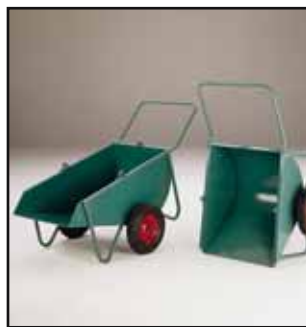
Figura 29 Carriola per materiali sfusi, benna a carrello. Per trasportare e ribaltare materiali sfusi (granulati, sabbia, rifiuti) del peso fino a 200 kg circa. Uso tipico: entrata e uscita merci, produzione, magazzino, manutenzione.
