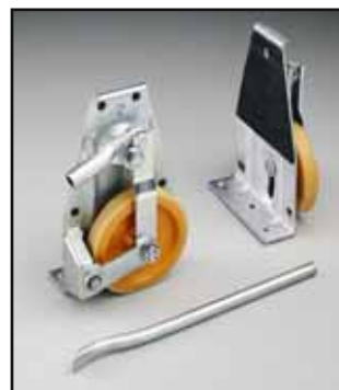
Figura 37 Rulli elevatori. Per spostare carichi pesanti e ingombranti quali armadi in acciaio, casse, contenitori del peso fino a 1000 kg circa. Uso tipico: ricezione merci, magazzino, consegna merci, manutenzione, traslochi.
