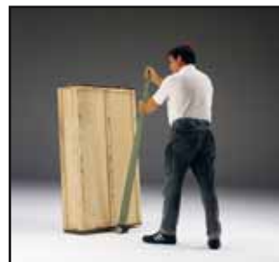
Figura 36 Leva a rulli. Per sollevare carichi di ogni tipo. Uso tipico: entrata e uscita merci, montaggio, magazzino, consegna merci, manutenzione, traslochi.
