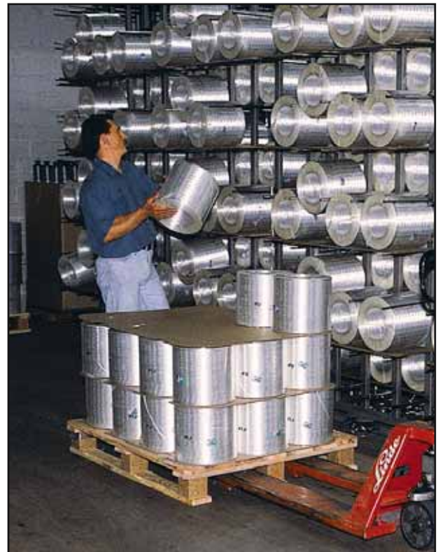
Figura 6: in passato le bobine di fibre di vetro del peso di 25 kg venivano posizionate manualmente per la lavorazione.
