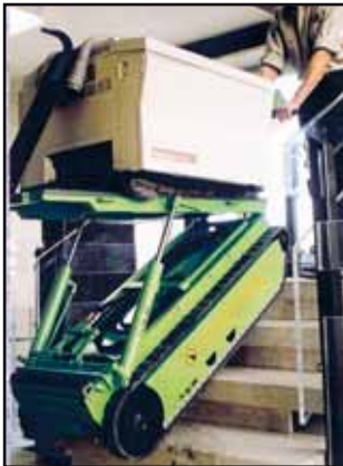
Figura 40 Trasportatore elettrico montagradini. Per spostare carichi pesanti e ingombranti quali armadi in acciaio, casse, contenitori del peso fino a 600 kg circa. Uso tipico: consegna merci, manutenzione, traslochi.
