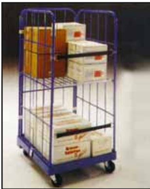
Figura 24 Carrello di commisionamento, carrello a cassone, carrello a scaffali. Per commissionamenti e trasporto di partite isolate. Uso: commissionamenti, entrata e uscita merci, montaggio, magazzino.
