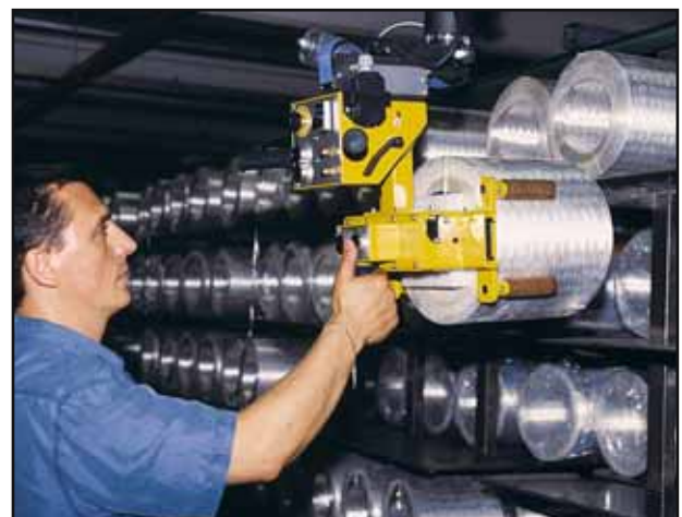
Figura 7: l'azienda ha imposto il motto «STOP – Pensa, poi solleva»: oggi lo stesso lavoro viene effettuato con un apparecchio di sollevamento («balancer» di pesi). Grazie alla meccanizzazione, il lavoro è diventato molto più sicuro, meno rischioso per la salute e la produttività è aumentata.
