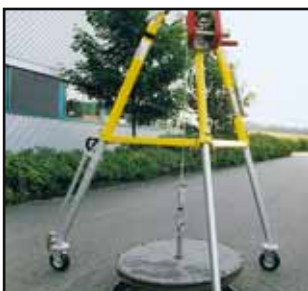
Figura 42 Apparecchi di sollevamento per chiusini stradali, argani. Per sollevare e spostare chiusini di ogni tipo del peso fino a 200 kg circa. Uso tipico: manutenzione, aziende municipali.
