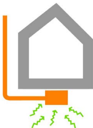
Figura 13: depressione del sottosuolo tramite pozzetto.
