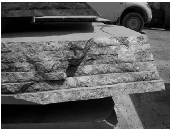
Figura 2: blocco di serpentinite massiccia dopo segazione a telaio. Si notino le sottili "spalmature" mineralizzate a crisotilo cross-fiber e calcite. .
