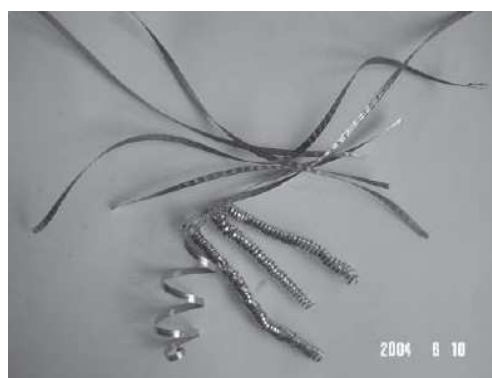
Fig. 11.3.c.2.1: trucioli di lega CuBe: a) ottenuti con taglio a secco; b) ottenuti con taglio umido.
