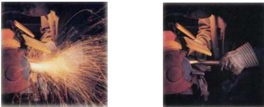
Fig. 10.9: il comportamento anti-scintilla delle leghe Rame-Berillio (a destra).
