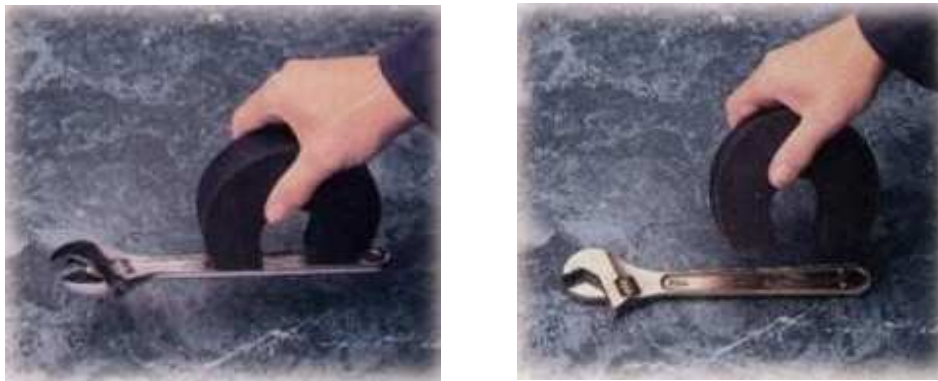
Fig. 10.8: il diverso comportamento magnetico delle leghe Rame-Berillio (a destra).
