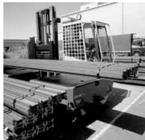
Figura 3: i profilati in acciaio devono essere tenuti assieme da fascette metalliche per evitare che possano cadere lateralmente dalle forche.
