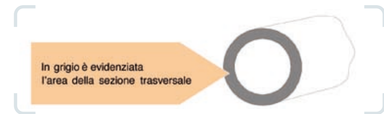
Fig. A6 - Indicazione della sezione trasversale di una tubazione soggetta a controllo OG.
