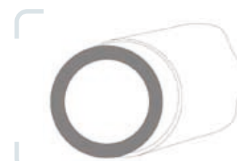
Fig. A10-a - Esempio di una riduzione distribuita di spessore.
