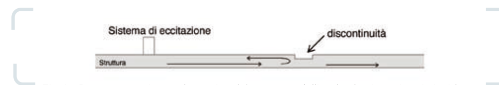
Fig. 1 - Rappresentazione schematica del percorso dell'onda elastica primaria incidente e di quello dell'onda riflessa a causa della presenza di una discontinuità.
