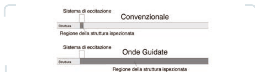
Fig. 2 - Rappresentazione schematica dell'approccio diagnostico del controllo ad Onde Guidate e quello del metodo ad Ultrasuoni.
