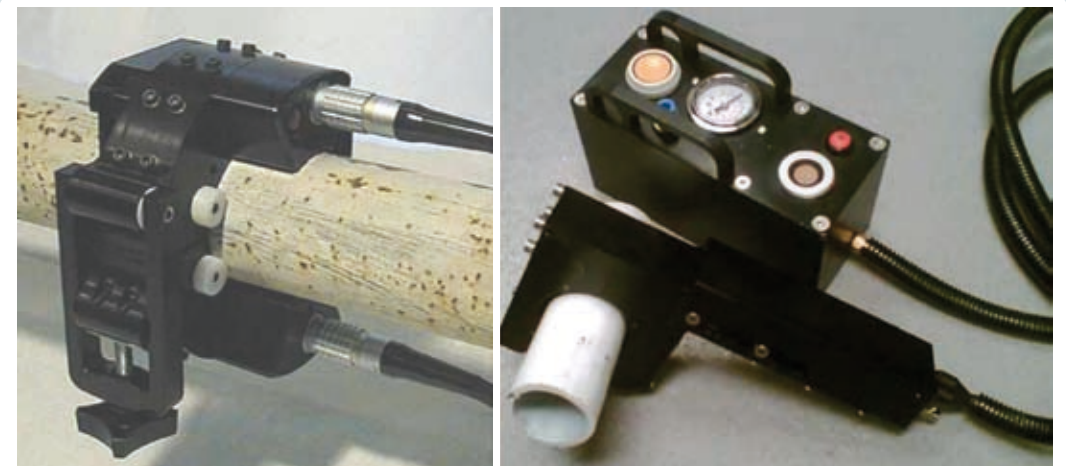
Fig. 9 - Sistemi di eccitazione ad anello rigido
