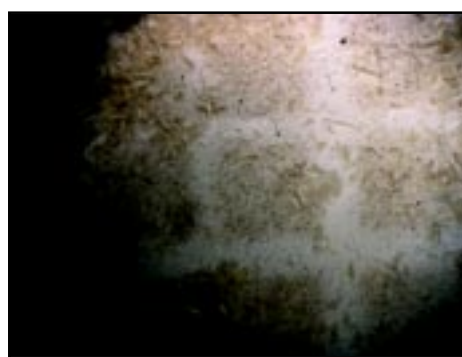
Figura 2.5: Immagini allo stereomicroscopio dell'insieme cestello-membrana di un campionatore IOM. È chiaramente visibile la polvere di legno depositata.
