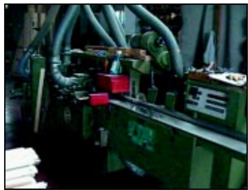
Figura 2.13: Macchine utensili dotate d'aspirazione localizzata della polvere di legno.
