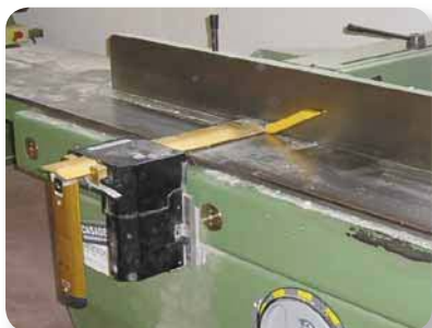
Ponte a regolazione automatica Modello con becchetto infilapezzo ribaltabile all'estremità del ponte; qui è posizionato in verticale per la piallatura sul piano
