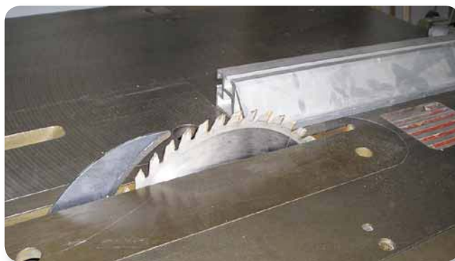
Guida in alluminio sfilabile / ribaltabile, qui in posizione bassa e arretrata
