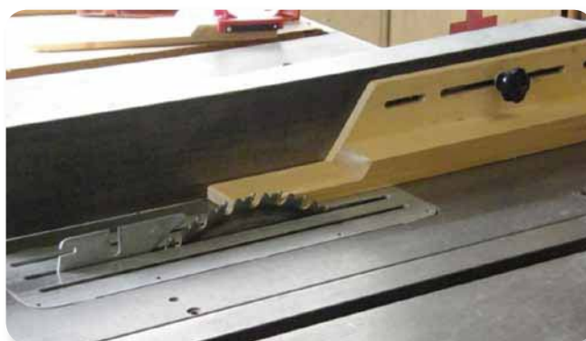
Guida bassa in legno autocostruita, fissata alla guida alta, regolabile parallelamente alla lama
