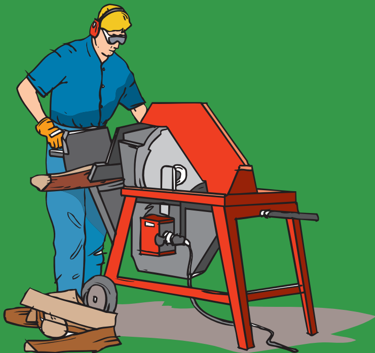
22. SEGARE LA LEGNA: USA SEGHE CIRCOLARI A BASCULA O CON PIANO MOBILE 61
