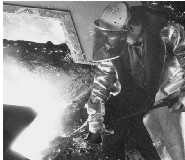
Figure 73.6 • Charge liquide pour convertisseur à oxygène
