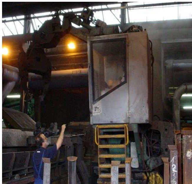
Foto 23 – Scarico getti con manipolatore.
