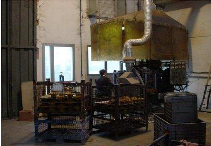
Foto 10 – Macchina per formatura anime (processo Hot Box), presidiata da cappa di aspirazione superiore.
