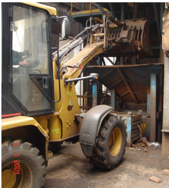
Foto 15 – Caricamento tramoggia skip di carica forni.
