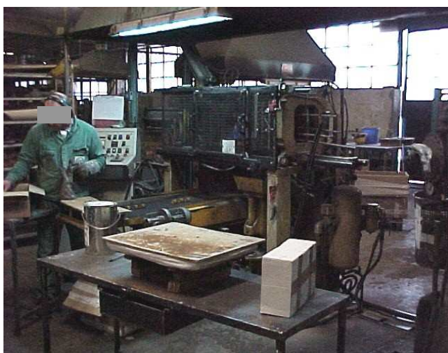
Foto 9 – Macchina per formatura anime (processo Shell molding) presidiata da cappa di aspirazione superiore.
