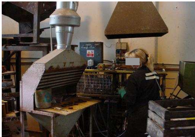
Foto 11 – Banco per finitura anime con aspirazione localizzata.
