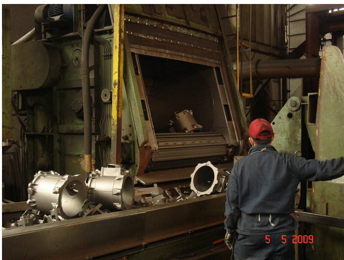
Foto 27 – Scarico getti da granigliatrice a Tappeto Rampante.
