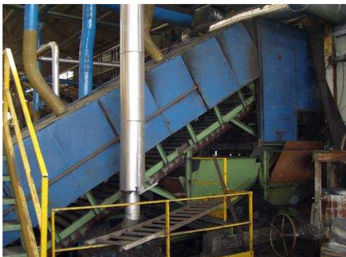
Foto 6 - Impianto di recupero terre a verde – vista nastro trasporto segregato ed aspirato.
