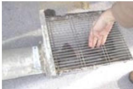
Verificare la presenza di un sistema di protezione (ad es. un grigliato) che impedisca di raggiungere le coclee attraverso la bocca di carico o scarico o quelle per il recupero mangime e brandeggiate.
