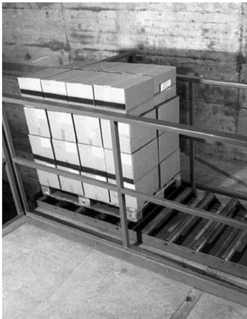
Figura 8: con i trasportatori a rulli è più difficile accedere al punto di caduta. Può anche essere posizionato un carico alto. L'ultimo rullo alle estremità deve essere bloccato con un arresto per impedire che la paletta possa cadere.
