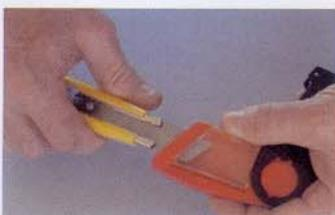
Dans le cas du cutter à lame sécable, ce réceptacle élimine le risque de coupure lors de la manipulation du bout de lame usée... (©M)
