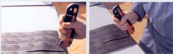
LA RÉTRACTION AUTOMATIQUE, EN IMAGE : la rétraction a lieu dès que la lame sort du matériau évitant ainsi les risques de coupure en fin de geste (©M)
