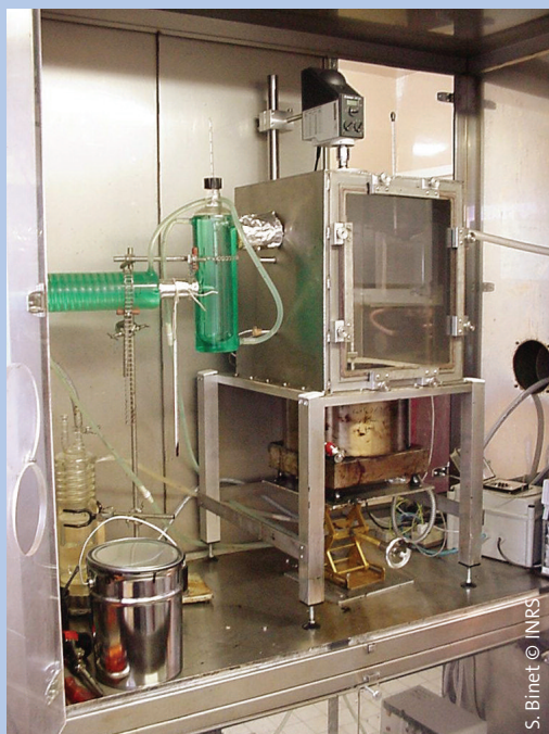
générateur de fumées de bitume
