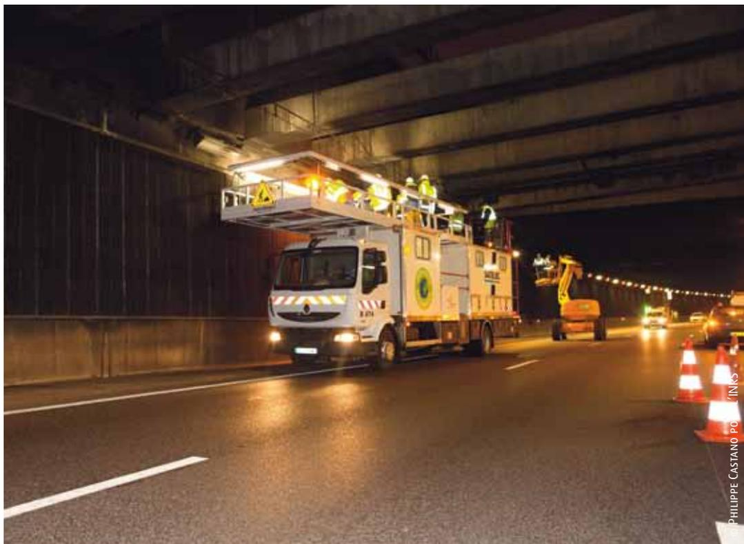
*Afin de faire face aux risques liés aux travaux de maintenance en tunnel, Satelec a imaginé son propre véhicule.*
