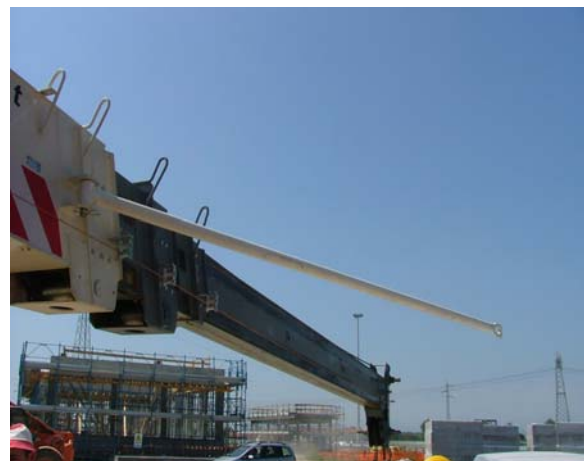
Figura 3. Braccio dell'autogru con asta asolata
