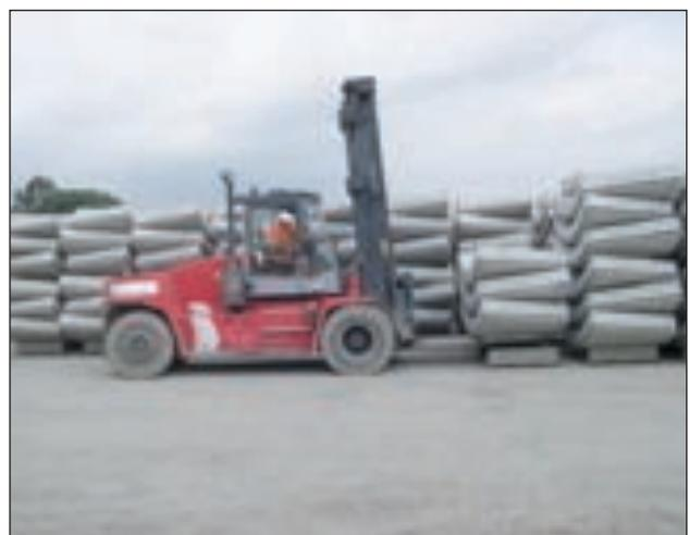
Quest'ultima caratteristica permette il trasporto di carichi con operazioni molto più semplici e più rapide e, nella generalità dei casi, con manovre di presa eseguite dal solo manovratore dell'automezzo senza l'ausilio di altri operatori, come accade nell'uso dei carrelli elevatori.
