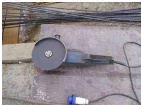
Utensile elettrico portatile B.T. dotato di mola abrasiva utilizzato per tagliare vari tipologie di materiali (calcestruzzo, laterizi, ferro, pvc, ecc).
