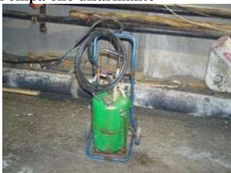
Pompa manuale costituita da un serbatoio cilindrico, contenente olio disarmante, e da una pompa a stantuffo che comprime l'aria. Tramite una lancia l'olio nebulizzato viene distribuito sulla superficie trattare
