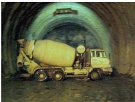
L'autobetoniera è una macchina utilizzata per il trasporto e il getto del calcestruzzo. Essa è costituita da un autotelaio e dalla betoniera vera e propria. La betoniera è composta da quattro principali componenti:
