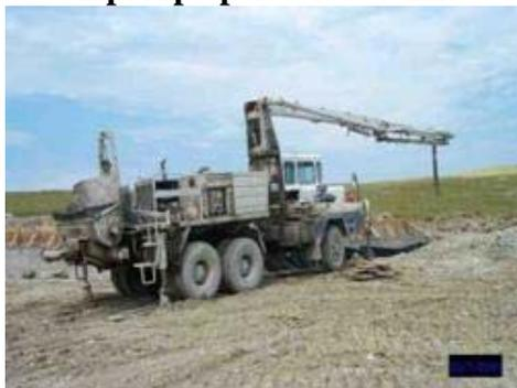
L'autopompa è costituita da un autotelaio, una pompa per calcestruzzo e un braccio di distribuzione.
