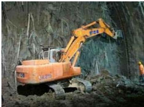
Macchina operatrice semovente su cingoli o ruote gommate, spinta da un motore endotermico diesel dotata di un braccio articolato alla cui estremità viene montata una benna.
