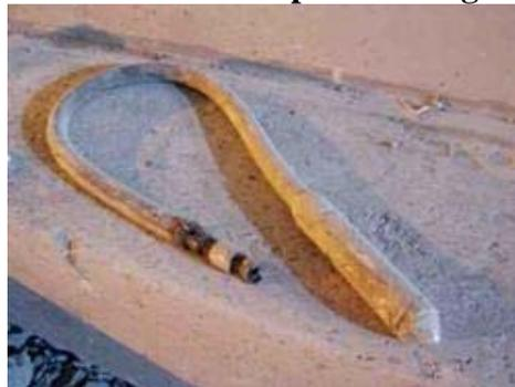
Attrezzo portatile pneumatico, costituito da un corpo metallico vibrante, utilizzato per la vibratura calcestruzzo
