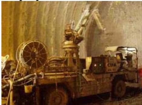
Macchina semovente su ruote spinta da un motore endotermico diesel.
