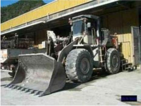
Macchina semovente a ruote, spinta da un motore endotermico diesel, provvista da una parte anteriore che funge da sostegno ad un dispositivo di carico; essa è progettata principalmente per il carico o lo scavo mezzo di una benna tramite il movimento in avanti della macchina.
