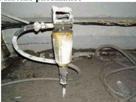
Utensile portatile demolitore usato per abbattere e perforare materiale di elevata consistenza.
