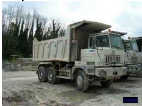
Il dumper è una macchina semovente dotata di cassone aperto ribaltabile e spinta da un motore endotermico diesel, a due assi, con quattro o sei ruote, introdotta abbastanza recentemente nel campo del movimento terra.
