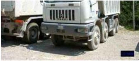
Il camion è una macchina semovente dotata di cassone ribaltabile e spinta da un motore endotermico diesel.
