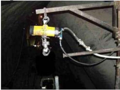
Argano elettrico o pneumatico, di portata inferiore a 200 Kg,
