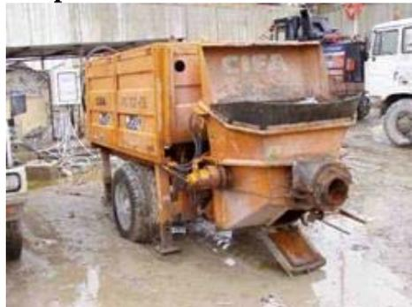
Struttura costituita da carrello monoasse con timone di traino, n°4 stabilizzatori a regolazione manuale
