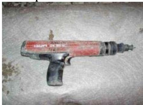
Apparecchio portatile sparachiodi utilizzato per fermare il tessuto non tessuto dell'impermeabilizzazione ai paramenti della galleria.
