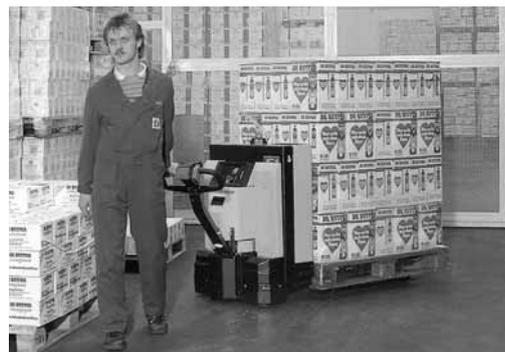
Figura 4: i carrelli di movimentazione provvisti di un timone lungo possono essere guidati con facilità e senza pericoli per i piedi.
