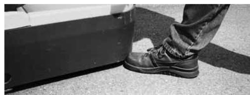
Figura 3: la piccola distanza fra il bordo del telaio e il pavimento (al massimo 35 mm) nonché l'uso delle scarpe di sicurezza offrono una protezione ottimale per i piedi.
