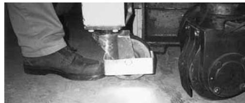
Figura 2: il copripneumatico e le scarpe di sicurezza proteggono i piedi del carrellista.
