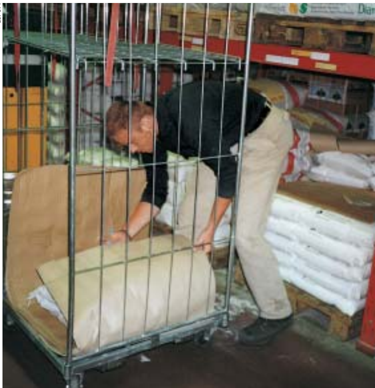
9 Questo carrello non è idoneo per trasportare sacchi. Apparecchi di trasporto non appropriati costringono l'operatore ad assumere una posizione sbagliata con il corpo togliendo i sacchi.
