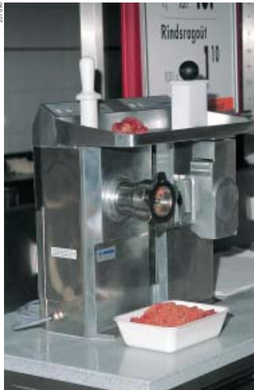
20 Tritacarne: sistema efficace di impedire l'introduzione delle dita nella zona della coclea.
