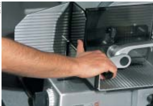
19 Affettatrice con copertura del tratto della lama non strettamente necessario al taglio.
