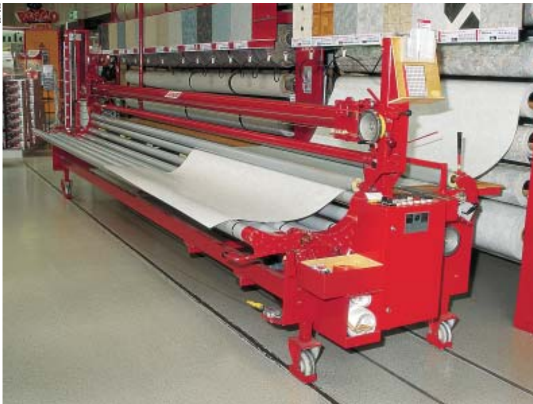
Macchina per tagliare tappeti – un'installazione tecnica sicura.
