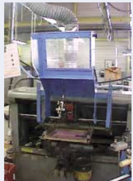
Le dispositif se soulève afin de faciliter le nettoyage de l'écran d'impression.
