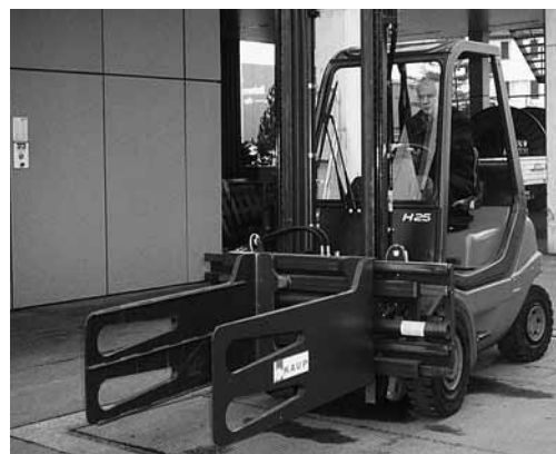
Figura 3: organo di presa per il trasporto di balle. Occorre usare sempre l'organo di presa appropriato.
