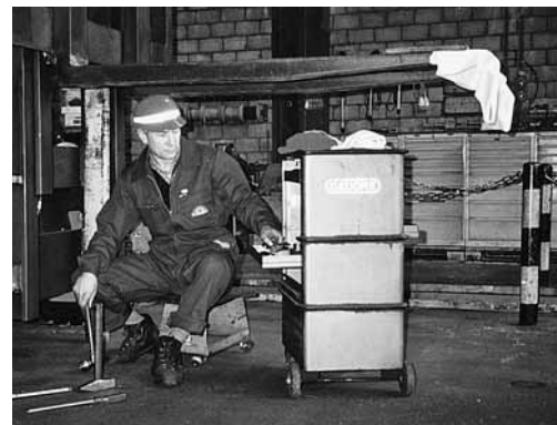
Figura 7: le forche, sotto le quali si devono eseguire lavori di manutenzione, devono essere protette contro l'abbassamento accidentale. La posizione rialzata delle forche deve essere segnalata.
