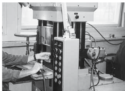
Fig. 4: alimentazione del pezzo da lavorare in una pressa provvista di dispositivo salvamano e schermo di protezione.
