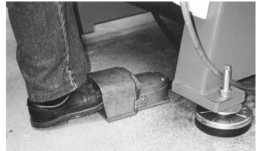
Fig. 2: il pedale deve essere equipaggiato con una robusta custodia.
