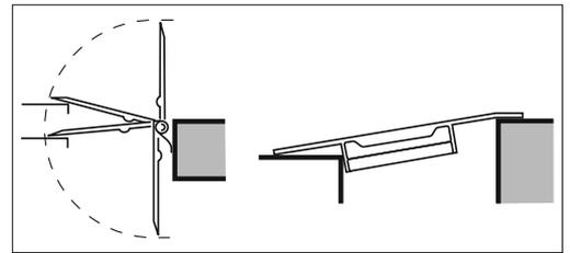
Esempio di una pedana protetta convenientemente. Peso massimo di una pedana:
