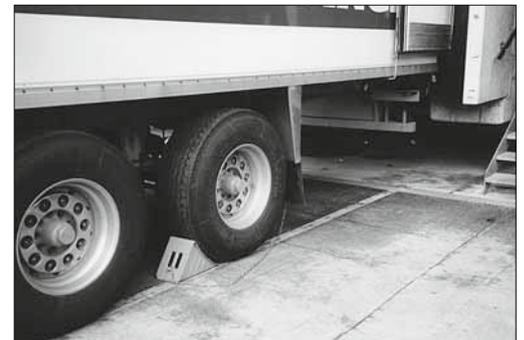
Il personale addetto alle operazioni di carico e scarico merci è sicuro che il veicolo le cui ruote sono state bloccate con l'apposito cuneo (calzatoio) non può mettersi in moto inavvertitamente.
