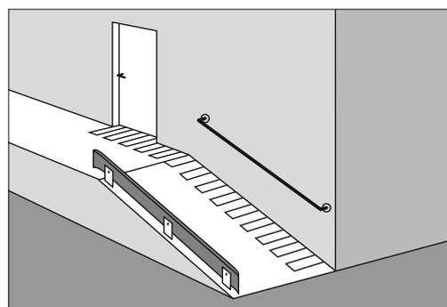
Rampa provvista di un robusto guardrail e di un corrimano.
