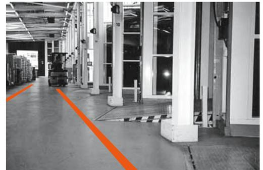
Fig. 3: Segnalazione delle rampe di carico e separazione con marcature della zona d'immagazzinamento dalla via di circolazione.
