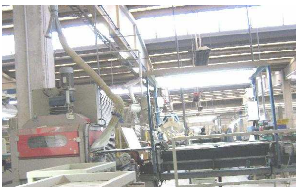
Apparecchiatura cabinata e aspirata per la spolveratura delle piastrelle: linea e particolare.
