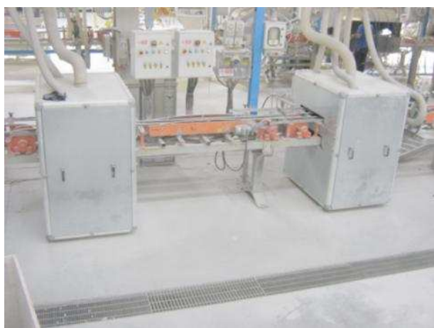
Chiusura ed aspirazione della sbavatura a secco.
