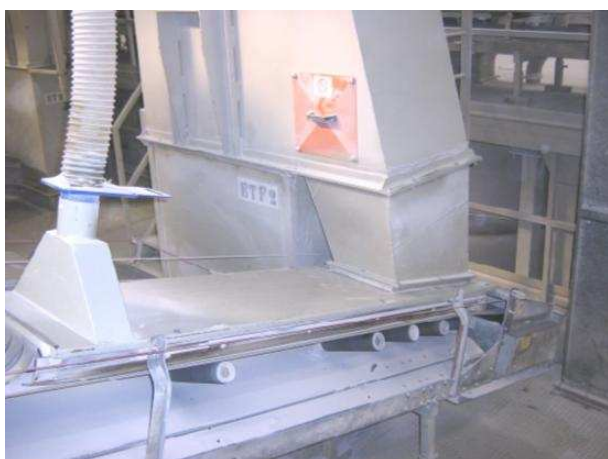
Nastro segregato e aspirato nel punto di caduta.
