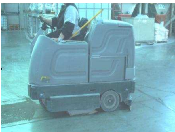
Pulitura ad umido del pavimento.
