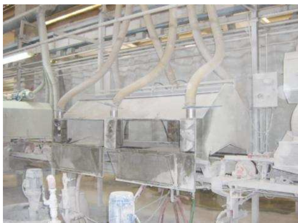
Spruzzatura airless di engobbia in capanno aspirato.
