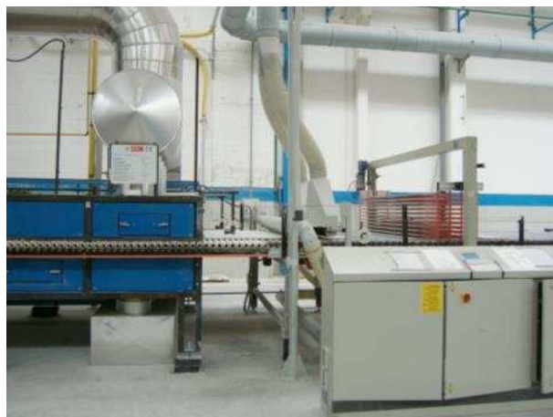
Soffiatura delle piastrelle e aspirazione delle polveri tra il polmone di alimentazione e l'ingresso forno.
