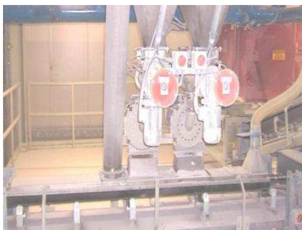
Alimentazione con nastri e condotte, trasporto con nastri chiusi e aspirati. A dx. micronizzatori a pioli.
