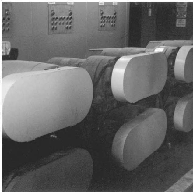
Figure 84.20 • Les protecteurs installés sur les machines prémunissent les opérateurs contre le contact avec des arbres en rotation, des courroies en mouvement et des chaînes d'entraînement
