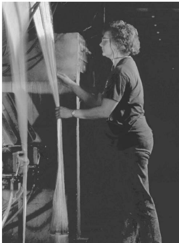
Figure 84.11 • Filaments de verre textile sortant de la filière. Rassemblés en mèches, ils sont ensuite bobinés pour être traités
