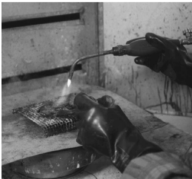
Figure 96.3 • Patinage du métal sous hotte d'aspiration à fente
