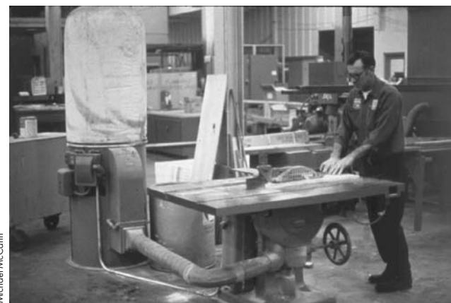
Figure 96.11 • Machines à bois équipées d'un dépoussiéreur
