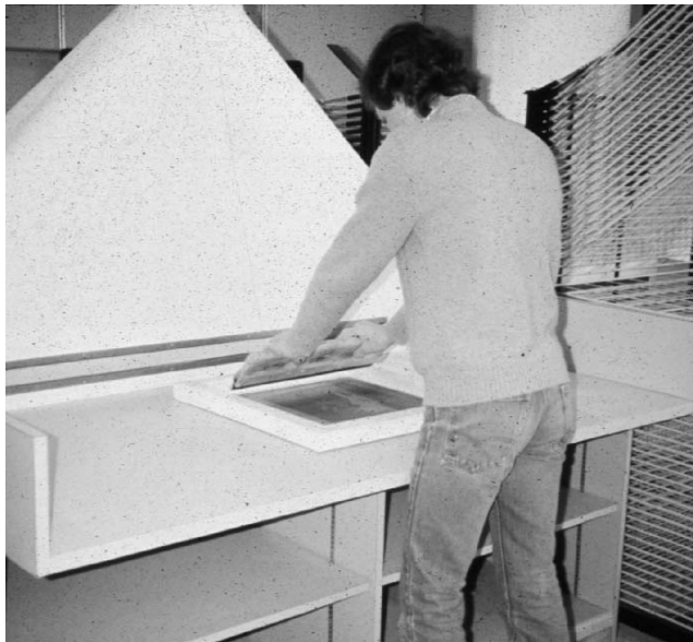
Figure 96.1 • Sérigraphie sur trame de soie sous hotte d'aspiration à fente
